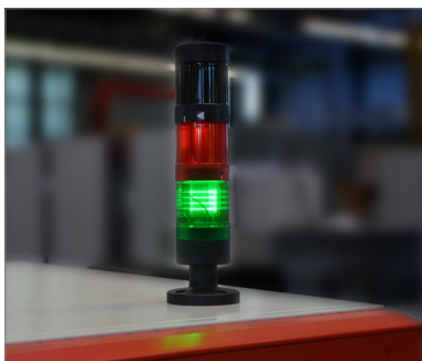
Indicatie voor programma-einde via indicatielamp
