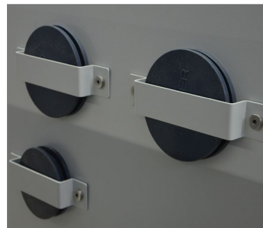
Doorvoerbeveiliging in geval van overdruk voor stabiele testcondities
