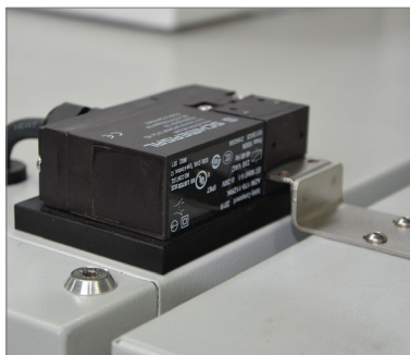
Elektromechanische deurvergrendeling aangestuurd via tijdprogramma of handmatig
